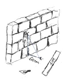
Pour savoir si son mur est bien vertical, un maçon utilise une règle de 1 m et fait une marque à 60 cm sur le sol et une autre à 80 cm du sol sur le mur. En plaçant la règle, il vérifie la verticalité du mur. Explique pourquoi.
