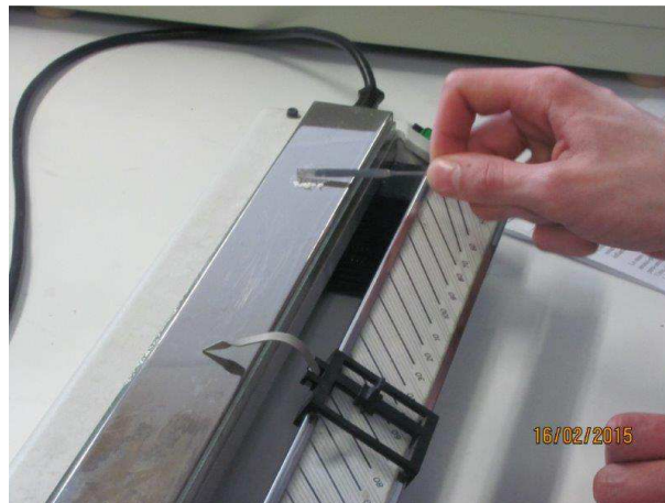
Expérience avec le banc Köfler pour vérifier la température de fusion du paracétamol et du savon synthétisés
